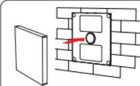
4. Setzen Sie den Drehschalter auf die Vorderseite des Halters.
