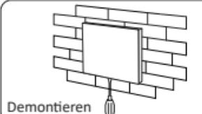
Stecken Sie einen Schraubendreher in das unten stehende Bajonetts und einen Schraubendreher nach oben, dann können Sie den Controller demontieren.
