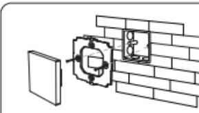
Befestigen Sie die Controller-Basis mit einer Schraube am unteren Gehäuse.
