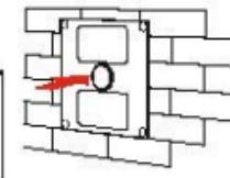
4. Setzen Sie den Drehschalter auf die Vorderseite des Halters.
