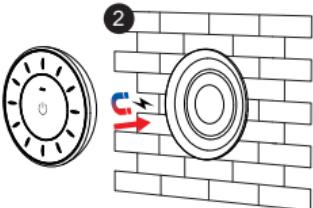
Kleben Sie die Basis gut fest, und die Fernbedienung wird magnetisch von der Basis angezogen
