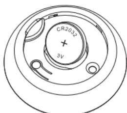
2. Installieren Sie die Batterie wie im Bild gezeigt (CR2032-Batterie muss separat erworben werden)
