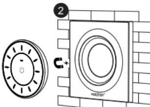
Ziehen Sie das doppelseitige Klebeband auf der Rückseite der Basis ab
