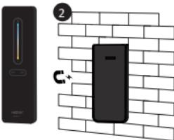
Kleben Sie die Halterung an die Wand und legen Sie die Fernbedienung in die Halterung
